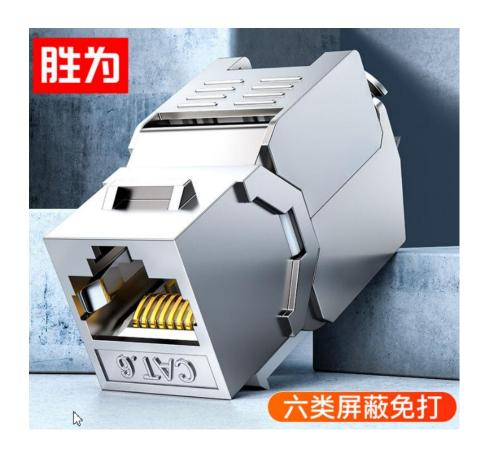
胜为六类屏蔽免打网络模块采用标准 8P8C RJ45 接口,优质 ABS 工程塑料主体,锌合金 屏蔽外壳,使得产品更坚固耐用、稳定可靠;磷青铜卡线柱,端口金针表面加厚镀金处理,接触电阻小、具有优良的阻抗匹配和回波损耗;核心 PCB 部件采用差分补偿技术,具有更高的 NEXT 串扰余量;免打线操作,产品自带线序标签;标准接口尺寸,可适用于各种不同品牌的网络面板、网络配线架上进行安装。为网络线路提供接续和延长作用。产品符合 YD/T 926. 3-2009、ISO/IEC 11801:2017、ANSI/TIA-568-C. 2-2009 标准要求。
