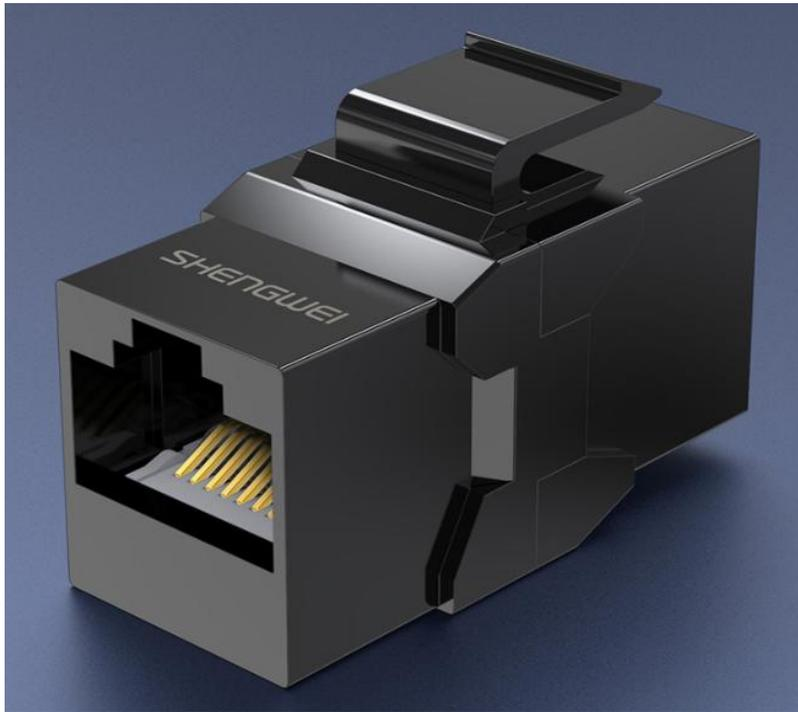
胜为超五类非屏蔽网络直通模块采用标准 8P8C RJ45 接口，优质环保 PC 工程塑料主体外壳，使得产品更坚固耐用、稳定可靠；金针表面加厚镀金处理，接触电阻小、具有优良的阻抗匹配和回波损耗；核心 PCB 部件采用差分补偿技术，具有更高的 NEXT 串扰余量；产品为 RJ45 端口转 RJ45 端口，免打线、即插即用，操作更方便；标准接口尺寸，可适用于各种不同品牌的网络面板、网络配线架上进行安装。为网络线路提供接续和延长作用。产品符合 YD/T 926.3-2009、ISO/IEC 11801:2017、ANSI/TIA-568-C.2-2009 标准要求。
