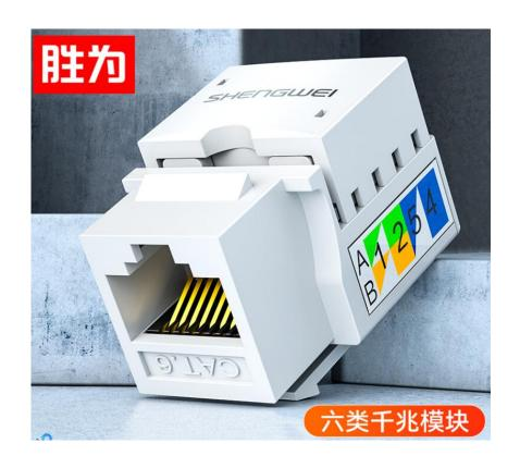
胜为六类非屏蔽网络模块采用标准 8P8C RJ45 接口,优质工程塑料外壳,高强度磷青铜打线柱,使得产品更坚固耐用、稳定可靠;金针表面加厚镀金处理,接触电阻小、具有优良的阻抗匹配和回波损耗;核心 PCB 部件采用差分补偿技术,具有更高的 NEXT 串扰余量;产品配有防尘压盖和线序标签,操作更方便;可适用于 100Base-Tx 百兆以太网、1000Base-Tx 千兆以太网、2.5GBse-Tx 2.5G 以太网等网络环境。为工作区终端设备和配线架提供网络连接端口作用。产品符合 YD/T 926.3-2009、ISO/IEC 11801:2017、ANSI/TIA-568-C.2-2009 标准要求。
